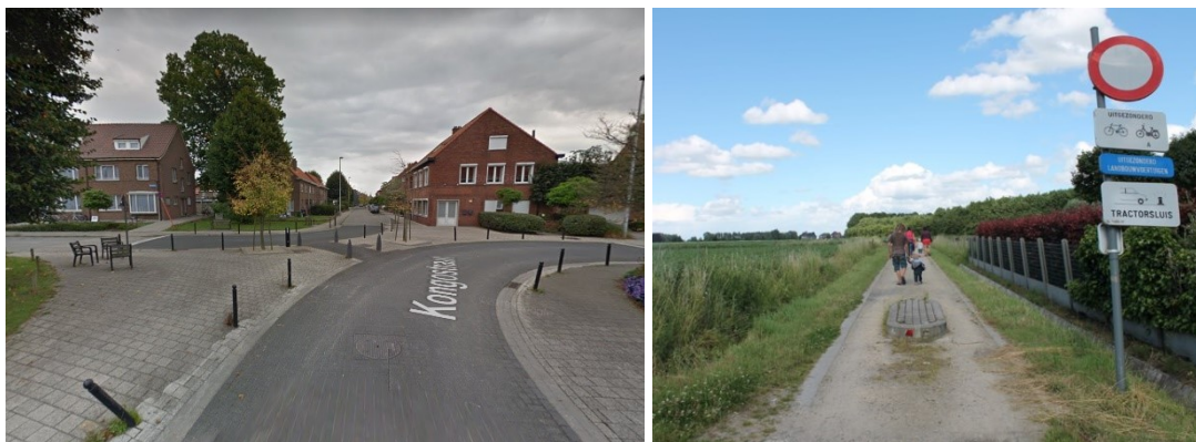
Figuur 111: Voorbeeld van diagonale knip in Turnhout (link) en tractorsluis (rechts)
