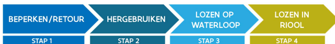
Figuur 29. Stappenplan VMM voor omgaan met bemaling van grondwater.
