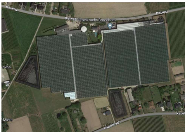
Figuur 54: Groeikracht Broechem heeft 2 opvangbekkens voor hergebruik regenwater.
